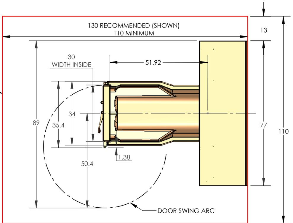
35 1/2 IN. MINIMUM DOOR OPENING WIDTH REQUIRED FOR TRANSPORTING TUB INTO THE ROOM.
